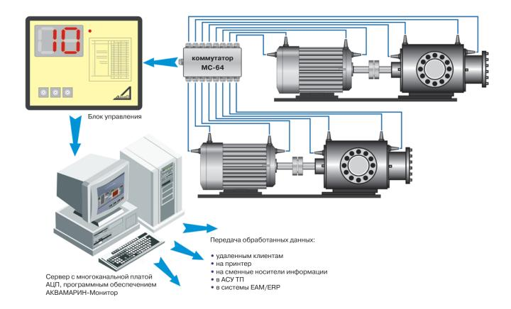
Система КОРУНД является логическим продолжением полустационарной системы на базе коммутирующих блоков МС-64, в котором все измерения и последующие расчеты автоматизированы. Данная система представляет собой совокупность первичных преобразователей (датчиков вибрации, частоты вращения, температуры, давления и т.д.), соединенных кабельными линиями с многоканальными коммутирующими блоками.
