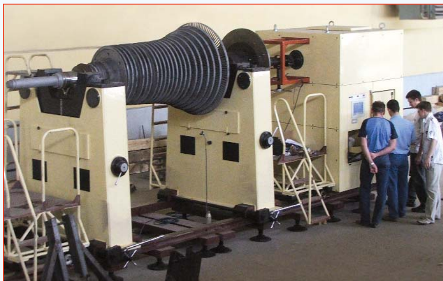
Рис. 1. Балансировочный станок ВМ-36000 грузоподъёмность 40 т
