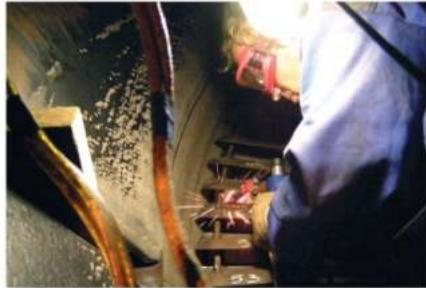
Процесс нанесения упрочняющего покрытия на лопатки турбины
