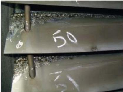
Лопатка с нанесенным покрытием
