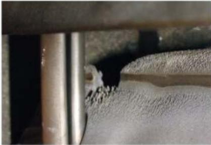
Разрушенная кромка лопатки
